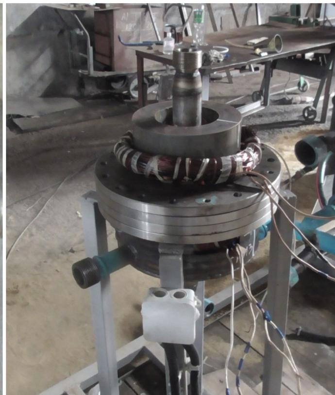
**Электромагнитный аппарат при сборке**
