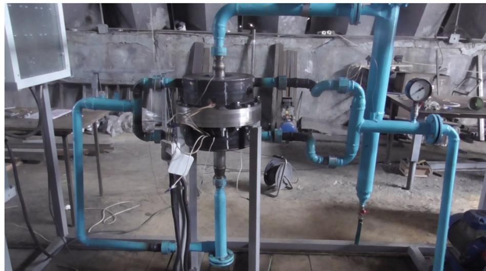
**Электромагнитный аппарат в составе технологической линии при сборке**
