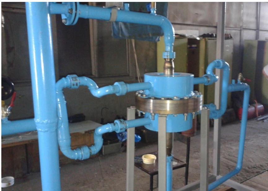
**Электромагнитный аппарат в составе технологической линии в сборе**
