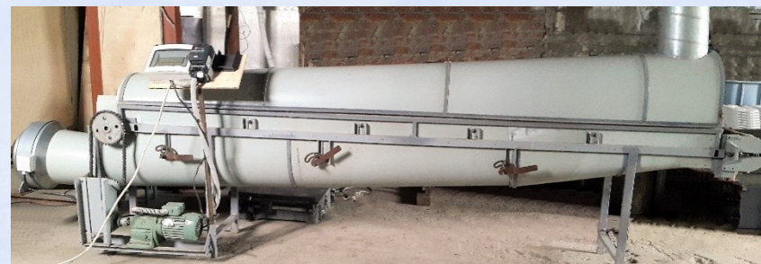
Рисунок 2 – Макет устройства для сушки и охлаждения гранул
