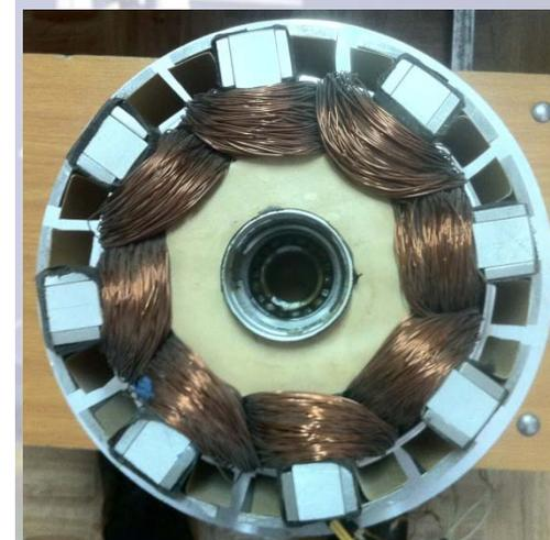
Синхронный генератор на постоянных магнитах, 2-статор, 3- катушка, 4-магниты, 5,6- вставки
