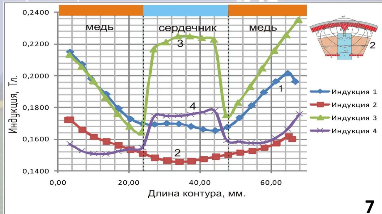
Моделирование физических процессов магнитной системы синхронного генератора в 3D редакторе для выявления недостатков модели и ее оптимизации;
