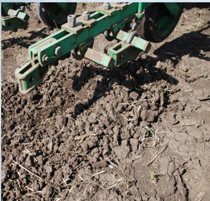
Вид спиральной лапы на секции пропашного культиватора КРН – 5,6
