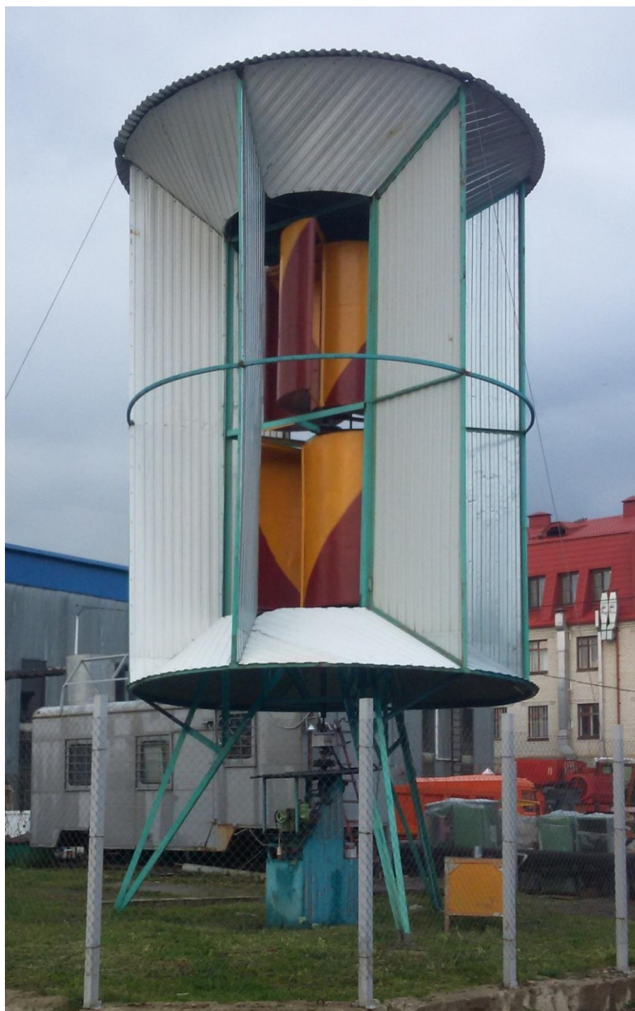
Общий вид вертикально-осевой двухроторной ветроэнергетической установки с кольцевым концентратором воздушного потока.
