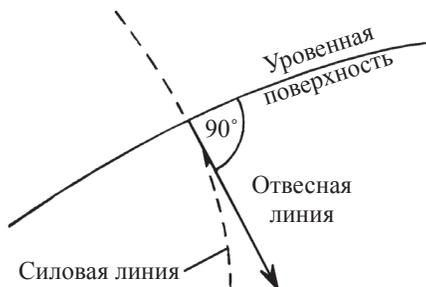
Рис. 4. Направление отвесной линии [11, с. 11]
