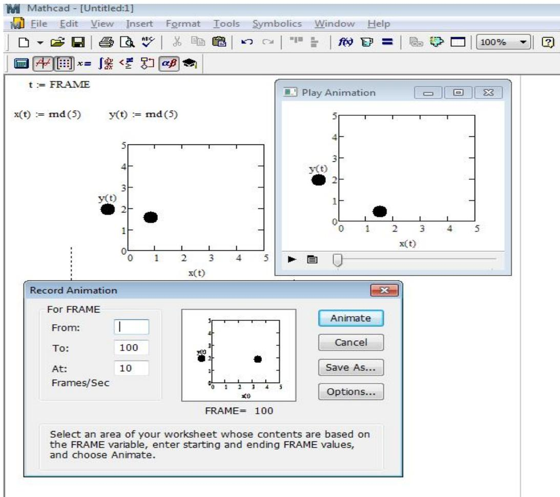
**Рис. 5.4 – Пример использования оператора счетчика кадров *FRAME***
