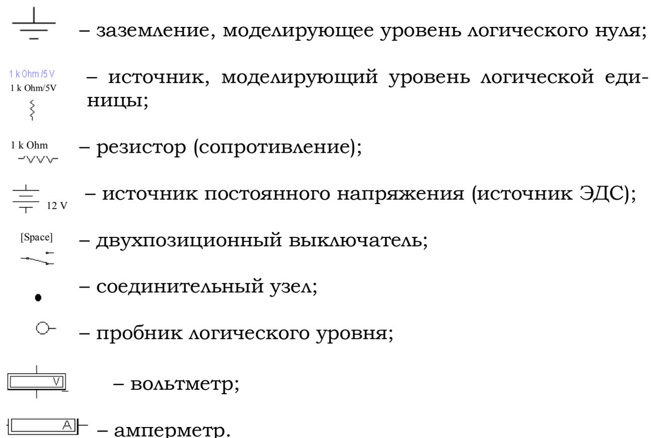
**Рисунок 1 - Основные элементы, используемые при моделировании и анализе электронных схем**
