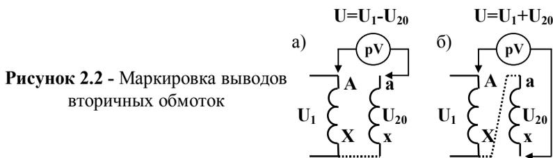
Рисунок 2.2 - Маркировка выводов вторичных обмоток
