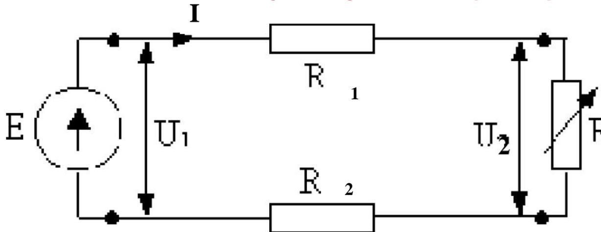
ЛЭП работает при неизменном напряжении источника  $U_1$  в начале линии
