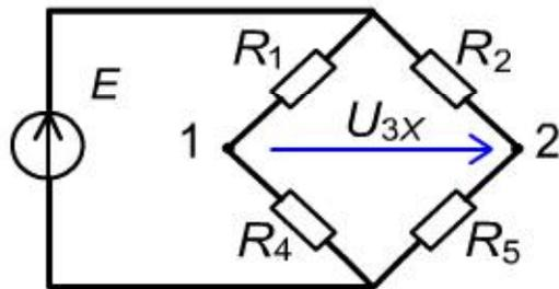
определяем рациональным методом напряжение  $U_{3X} = E_{ЭГ}$ , например как разность напряжений на участках  $R_4$  и  $R_5$ .
