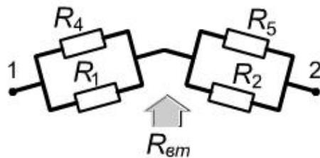
2. Сопротивление  $R_{ем}$  между зажимами 1 и 2 при  $E = 0$  и разомкнутой ветви  $R_3$
