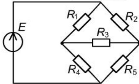
Определить ток  $I_3$  диагональной ветви схемы.
