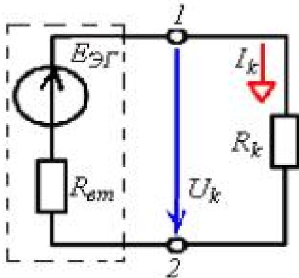
где  $E = U_{Xk}$  - ЭДС ЭГ, равная напряжению холостого хода между зажимами **1** и **2** отключенного пассивного элемента ветви с сопротивлением  $R_k$ ;
