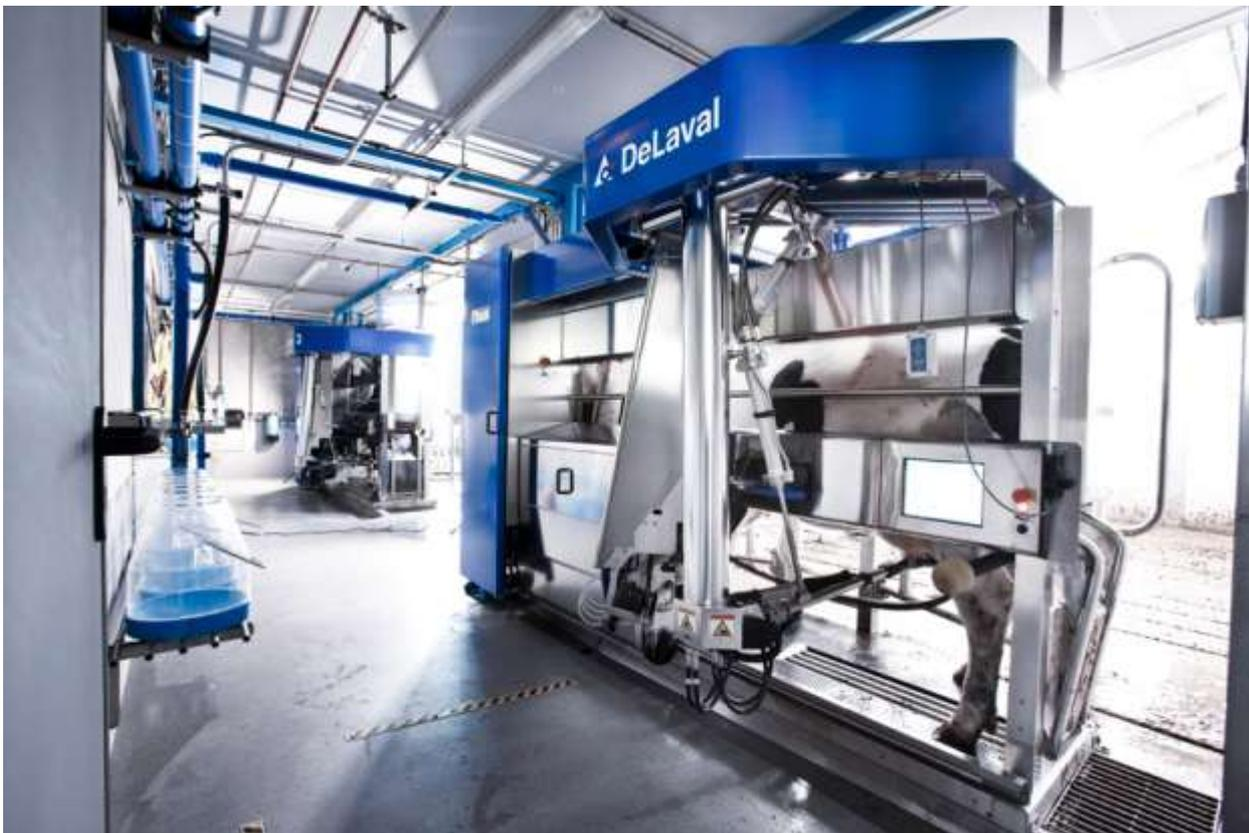
**Рисунок- Система добровольного доения - РОБОТ VMS**
