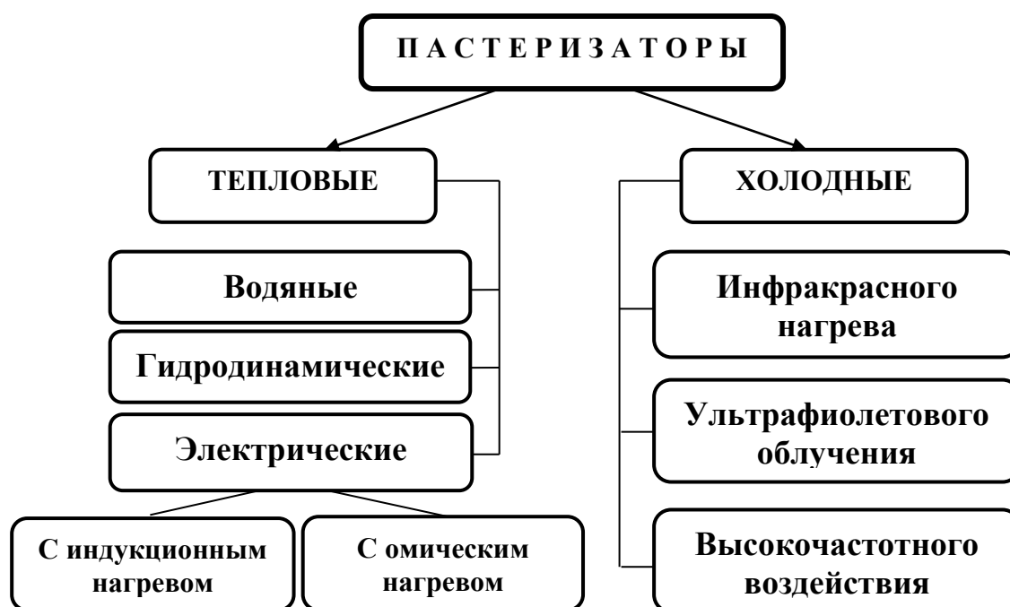
Рисунок 11.26 – Классификационная схема пастеризаторов
