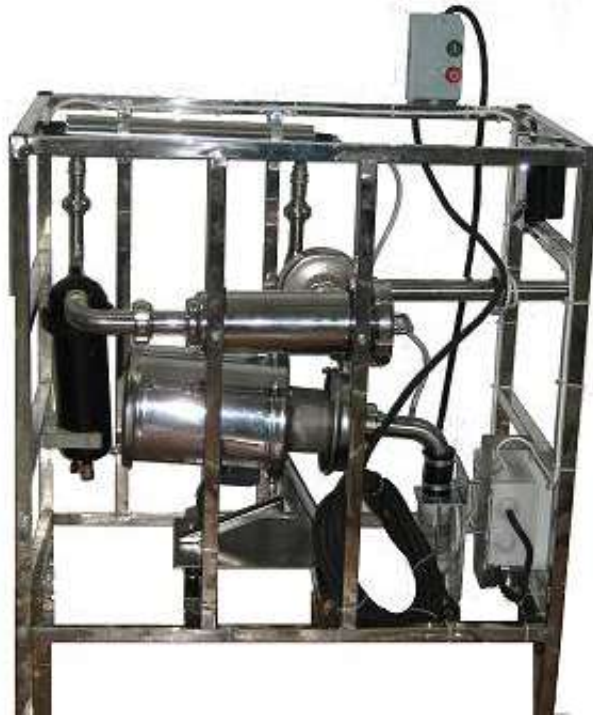
Рисунок 11.8 – Комплекс очистки и обеззараживания молока производительностью 2 т/ч
