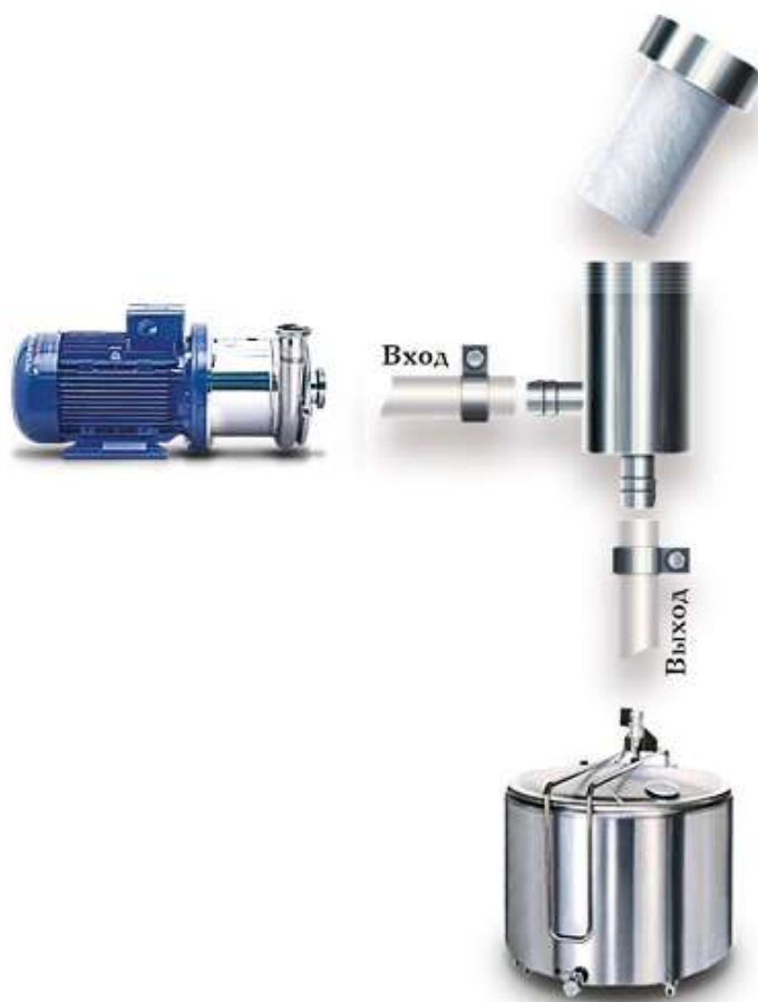
Рисунок 11.6 – Схема установки фильтра в молочную линию
