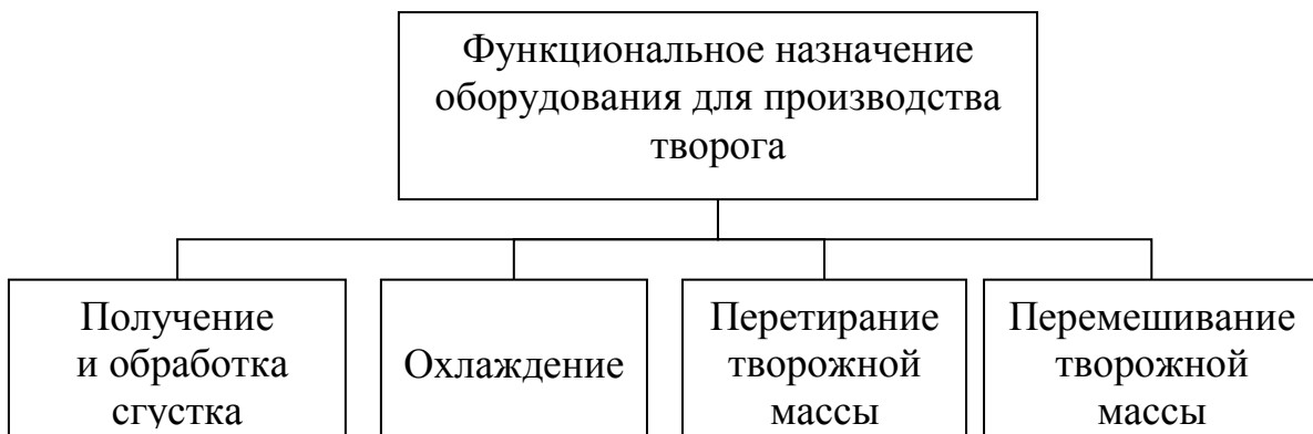
Рисунок 11.55 – Классификационная схема оборудования для производства творога
