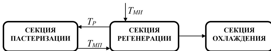
Рисунок 11.28 - Схема процесса регенерации
