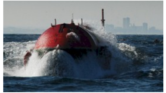
Рис.5.44. Конвертеры волновой энергии первой в мире волновой электростанции Pelamis P-750 (Португалия).
