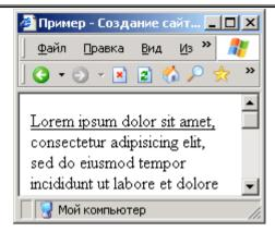
Рисунок 3.20. Пример использования псевдокласса first-line.
