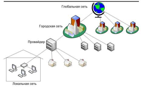
Рисунок 1.1. Объединение сетей в Интернет
