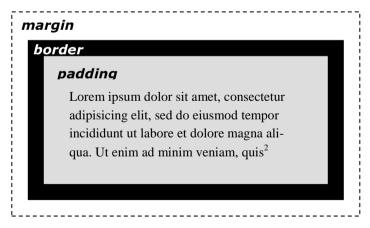
Рисунок 3.3 Бокс (box) элемента.
