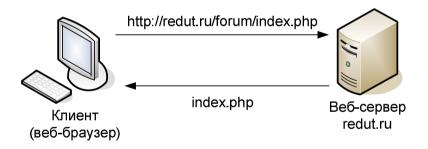
Рисунок 1.2. Механизм взаимодействия
