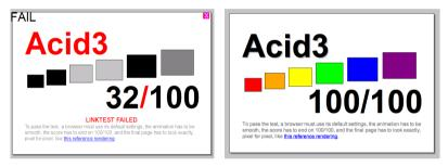
Рисунок 4.3. Прохождение теста Acid3 браузером Internet Explorer 8 (слева) и Opera 10 (справа).
