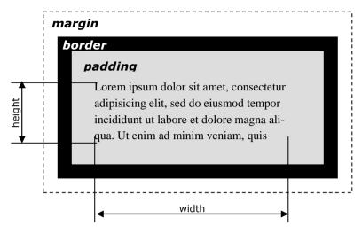
Рисунок 3.8. Бокс элемента и размеры содержимого
