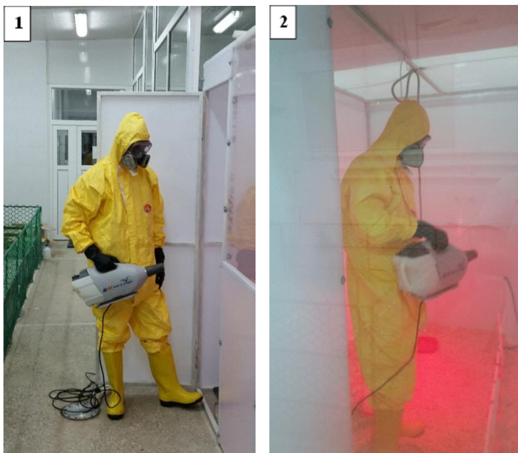
Рисунок 9 – Проведение аэрозольной дезинфекции генератором холодного тумана SM B-100: 1 – подготовка; 2 – процесс проведения аэрозольной дезинфекции
