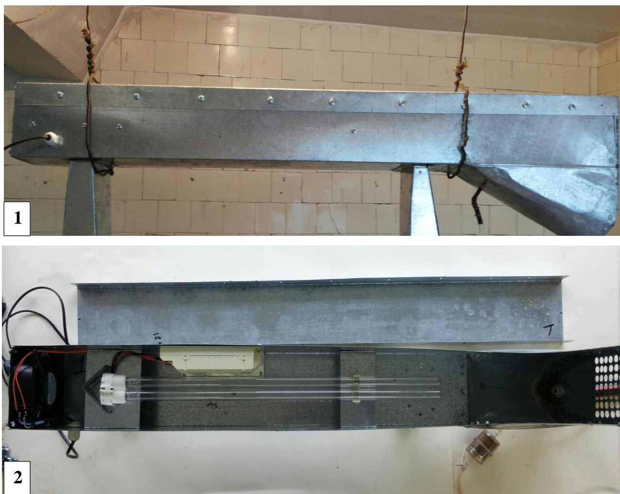
Рисунок 14 – «Рециркулятор вентилируемого воздуха»: 1 – общий вид; 2 – вид сверху. Патент на изобретение № 2600792 от 4.10.2016 г. [70]
