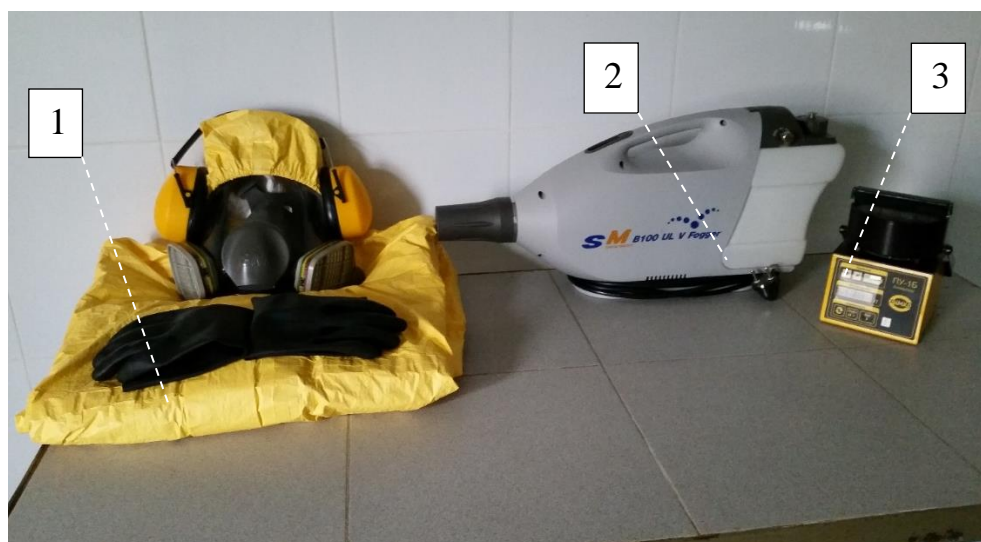
Рисунок 8 – Средства индивидуальной защиты – 1, генератор холодного тумана SM В-100 (Южная Корея) – 2, прибор для отбора проб воздуха ПУ-1Б (Россия, ЗАО «Химко») – 3
