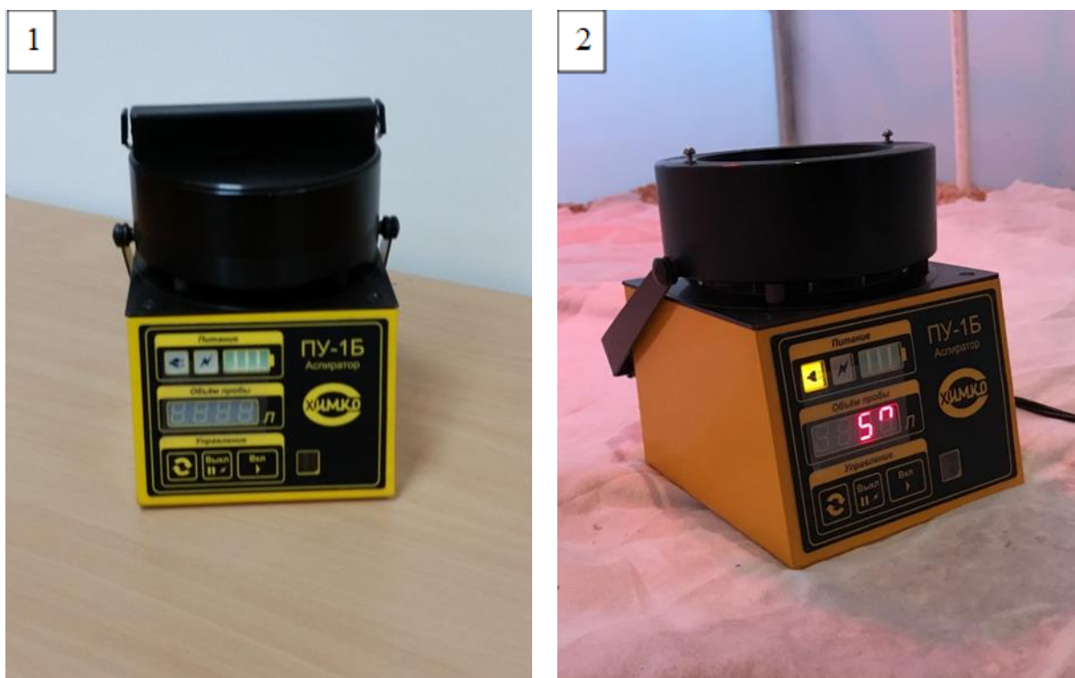
Рисунок 12 – Общий вид прибора ПУ-1Б – 1, прибор ПУ-1Б в режиме работы 50л (Россия, ЗАО «Химко») – 2
