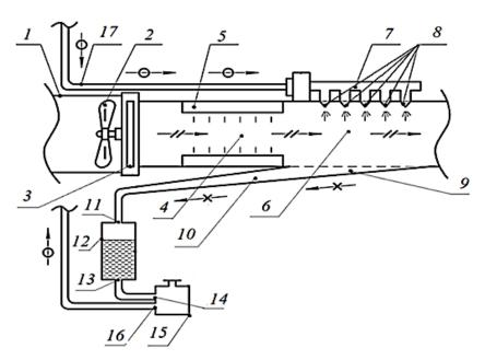
Рисунок 3 — Схема устройства «Рециркулятор вентилируемого воздуха» (Пат. на изобретение № 2600792 от 04.10.2016):
