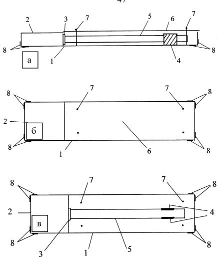
Рисунок 8 — Устройство для обеззараживания воздуха (Патент на изобретение № 2758633 от 01.11.2021):
