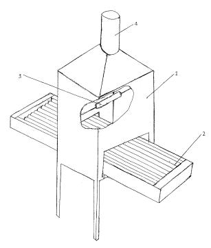
Рисунок 1 — Устройство для предынкубационной обработки яиц (патент № 2014113523/13 от 27.03.2017):
