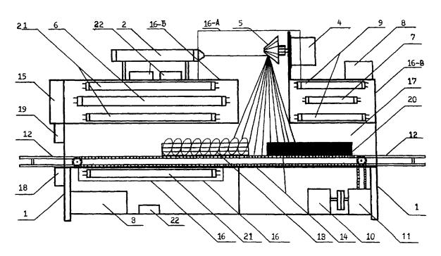
Рисунок 2 — Схема «Установка для светолазерной обработки и дезинфекции яиц сельскохозяйственной птицы»
