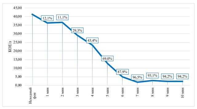
Рисунок 9 — Изменение количества КОЕ/л в воздухе во время работы «Устройства для обеззараживания воздуха»
