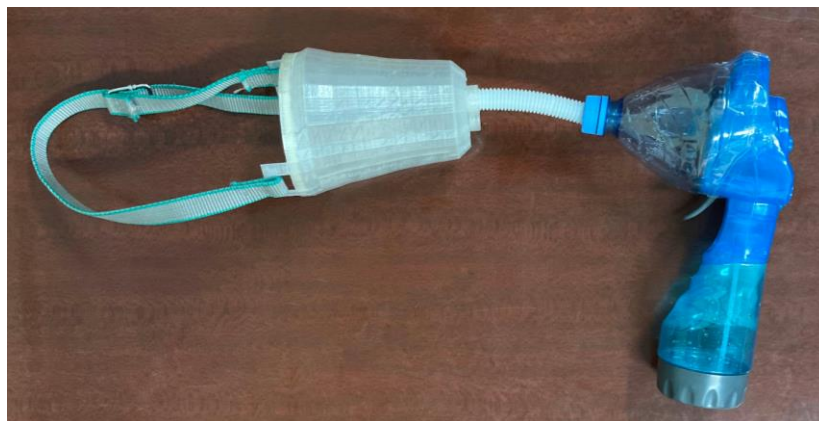
Рисунок 13 - Автономный, компрессионный, полуавтоматический ингалятор с системой подачи аэрозоля озонированного физиологического раствора
