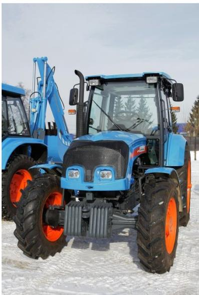
Самоходные шасси мощностью 30 и 50 л.с.: АГРОМАШ 30СШ и АГРОМАШ 50СШ с возможностью агрегатирования их самопогрузочным оборудованием и вилочным погрузчиком являются уникальным продуктом производства ОАО «САРЭКС». Самоходные шасси имеют компактные размеры и высокую грузоподъемность, что обеспечивает возможность их применения в стесненных условиях без потери производительности.
